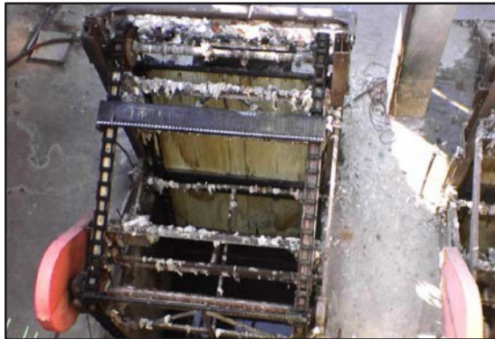
Parrilla en operación antes de recubrir.
